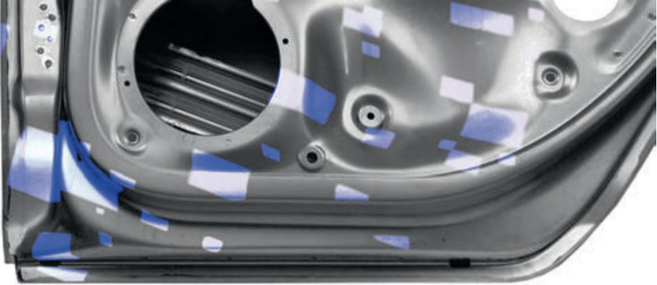
**Планирование инспекции** — Набор CAD данных может импортироваться вместе с соответствующим планом измерений. Сохраненные в плане измерений, инспекционные элементы автоматически распознаются программным обеспечением. Отчет по измерениям может быть также подготовлен заранее в автономном режиме. Фактические результаты измерений будут отображены после выполнения реальной процедуры измерения.
