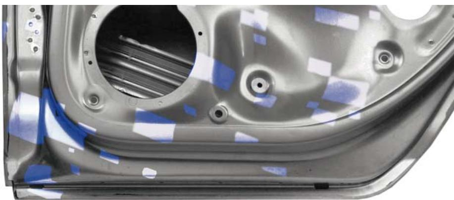
**Планирование инспекции** — Набор CAD данных может импортироваться вместе с соответствующим планом измерений. Сохраненные в плане измерений, инспекционные элементы автоматически распознаются программным обеспечением. Отчет по измерениям может быть также подготовлен заранее в автономном режиме. Фактические результаты измерений будут отображены после выполнения реальной процедуры измерения.
