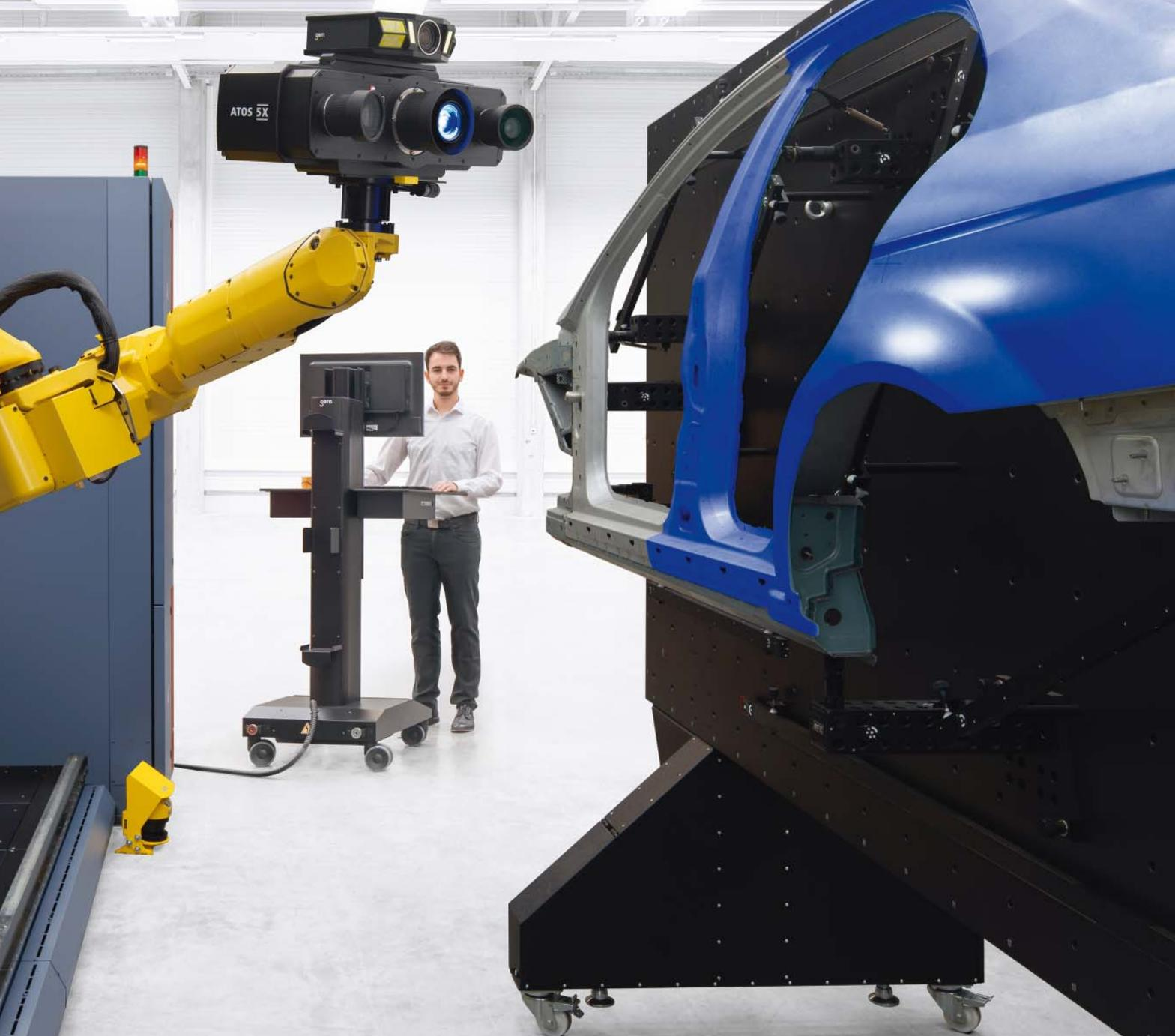
ATOS ScanBox серийно выпускаемая 3D измерительная машина, разработанная компанией GOM для быстрого и эффективного контроля качества на производстве. Несколько сотен автоматизированных систем ATOS ScanBox установлено по всему миру, они успешно используются в различных отраслях промышленности. Существует десять моделей для различных размеров деталей и областей применения.
