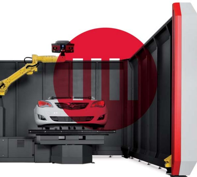
ATOS Professional — это программное обеспечение, которое управляет системой ATOS, получает точные 3D данные поверхности объекта, а также имеет возможность проводить полный инспекционный контроль геометрии и создавать необходимые отчеты, в одном программном пакете.
