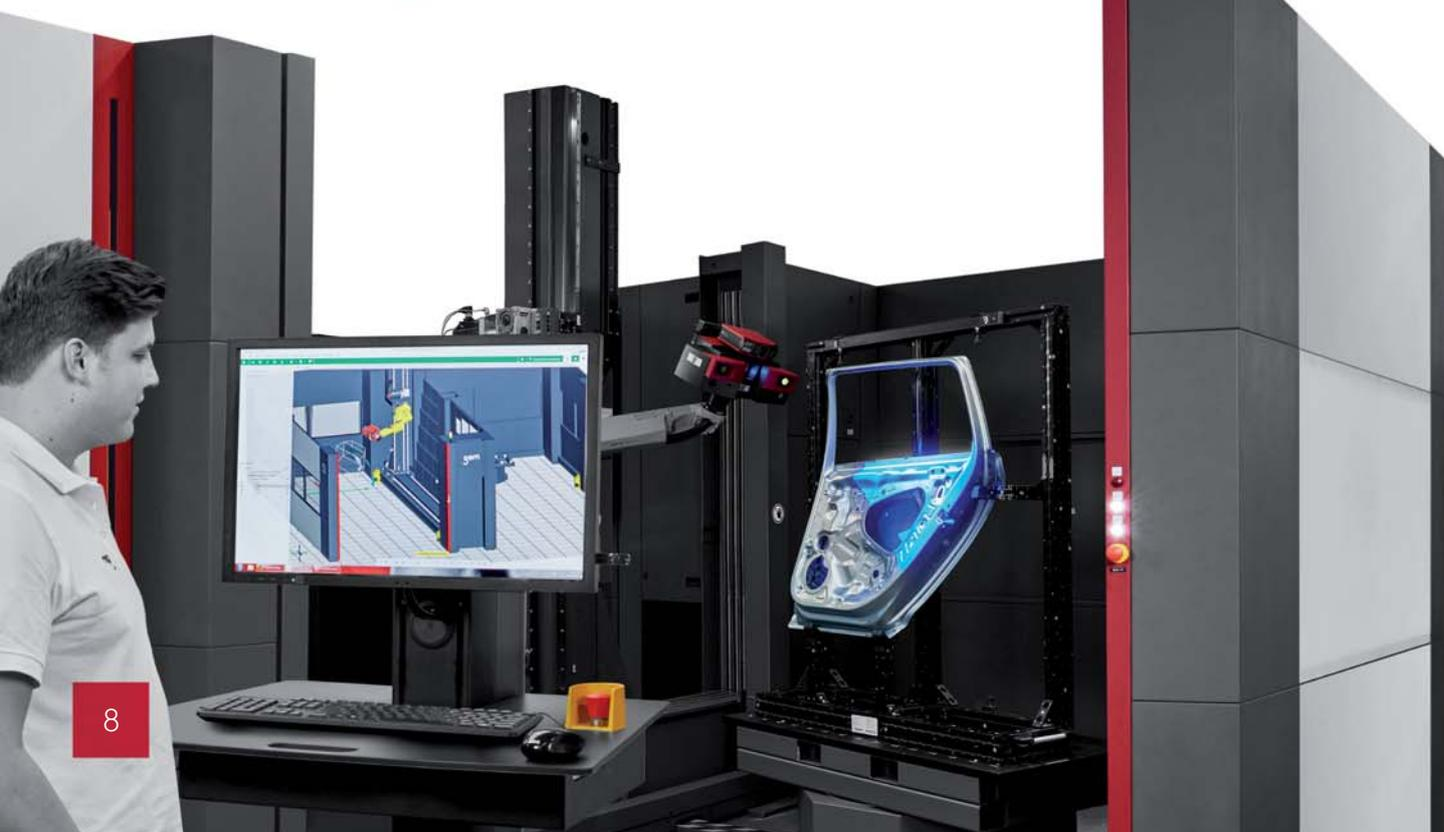
ATOS ScanBox представляет собой оптическую 3D измерительную машину, которая была полностью разработана фирмой GOM, для эффективного контроля качества в процессе разработки и изготовления деталей. ATOS ScanBox используется на нескольких сотнях предприятий в разных отраслях промышленности по всему миру. Девять моделей доступны для различных размеров деталей и областей применения.
